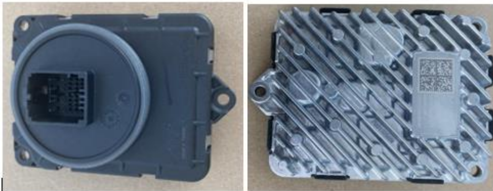
Controlador de LEDs, lado frontal com conector de pino para conexão do chicote elétrico e lado inverso com o dissipador de calor
